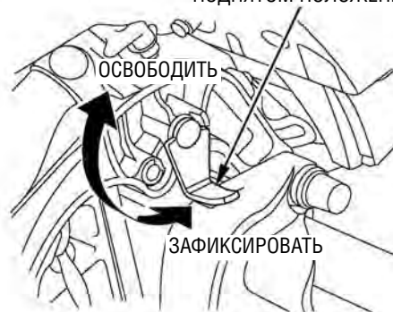
РЫЧАГ ФИКСАТОРА МОТОРА В ПОДНЯТОМ ПОЛОЖЕНИИ
