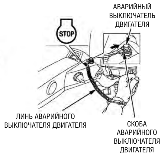
ЛИНЬ АВАРИЙНОГО ВЫКЛЮЧАТЕЛЯ ДВИГАТЕЛЯ
