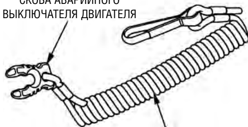
ЛИНЬ АВАРИЙНОГО ВЫКЛЮЧАТЕЛЯ ДВИГАТЕЛЯ
