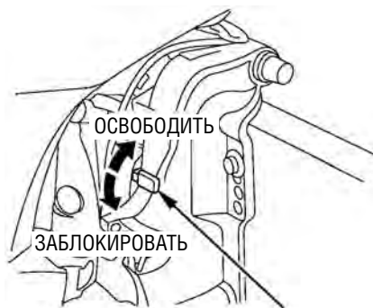
РЫЧАГ МЕХАНИЗМА ПОДЪЕМА ИЗ ВОДЫ
