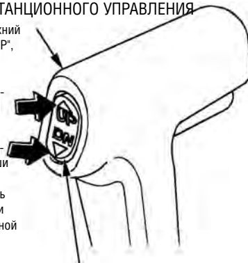
ВЫКЛЮЧАТЕЛЬ СЕРВОПРИВОДА РЕГУЛИРОВКИ НАКЛОНА/ПОДЪЕМА ИЗ ВОДЫ
